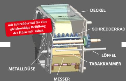
**DAS GERÄT FUNKTIONIERT NICHT, WENN DER DECKEL GEÖFFNET IST!**
